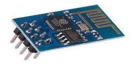
Fig.3. ESP8266 Wi-Fi Module
