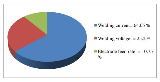
PIE CHART REPRESENTATION OF PERCENTAGE CONTRIBUTION OF PROCESS PARAMETERS FOR TENSILE STRENGTH
