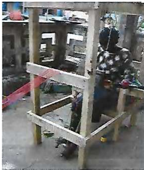
Fig. 2 Horizontal Loom: - 138cm/79cm/ 154cm,
